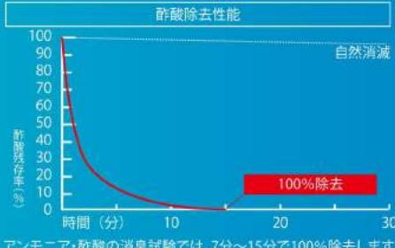
アンモニア・酢酸の消臭試験では、7分～15分で100%除去します。
